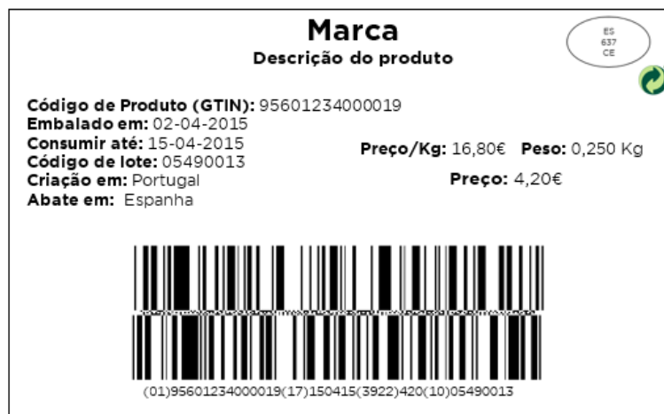
Figura 6 - Etiqueta-exemplo para utilizar na unidade de consumo (GS1 DataBar) com o preço do produto codificado em código de barras
