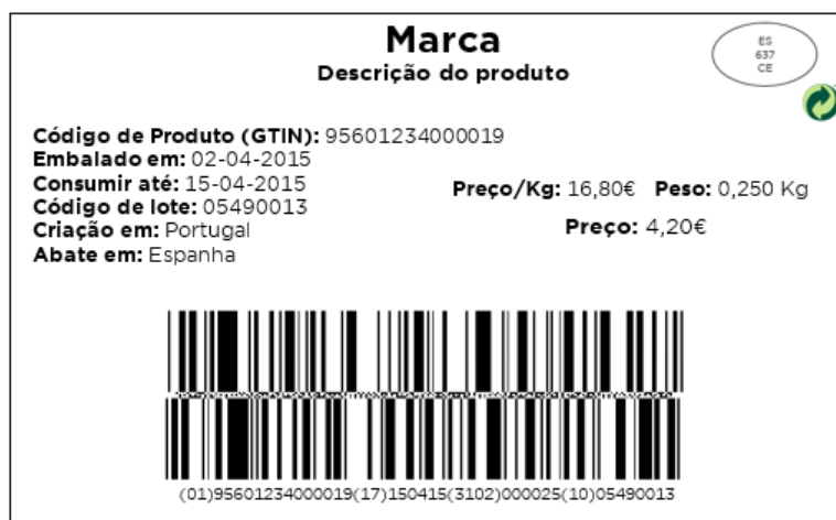
Figura 7 - Etiqueta-exemplo para utilizar na unidade de consumo (GS1 DataBar) com o peso líquido do produto codificado em código de barras
